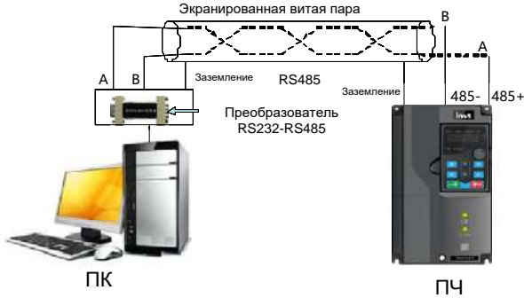
Рис. 9–1 Подключение RS485 на одном ПЧ
