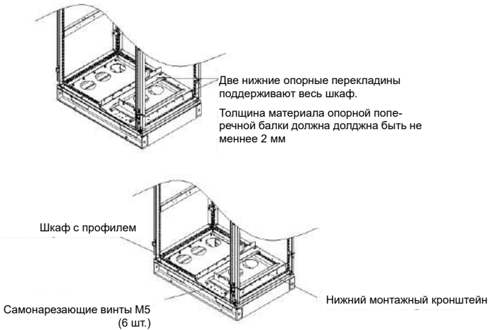
Рис. 4–13 Схема нижнего монтажного кронштейна
