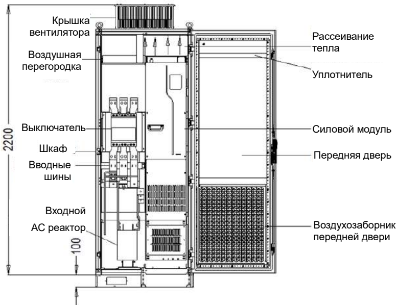
Рис. 4–10 Рекомендуемая компоновка шкафа
